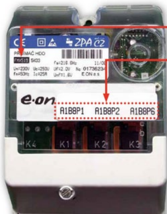
Obrázek 8: Jedna z možností přijímače HDO
